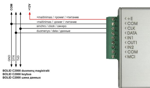
Siųstuvo T10R (T10UR) prijungimo schema prie BOLID C2000 apsaugos centrų.
